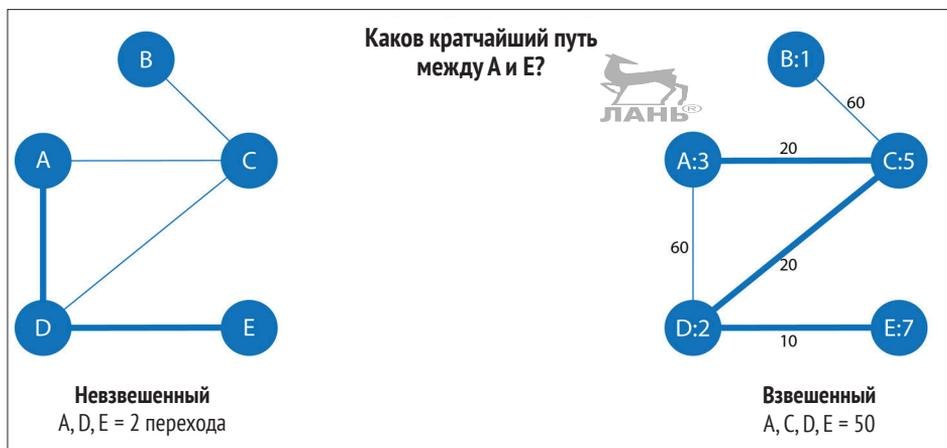
**Рис. 2.6.** При использовании невзвешенных и взвешенных графов кратчайшие пути могут различаться
