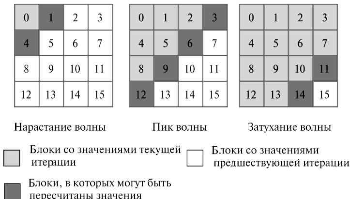
**Рис. 11.13.** Организация волны вычислений при блочной схеме разделения данных
