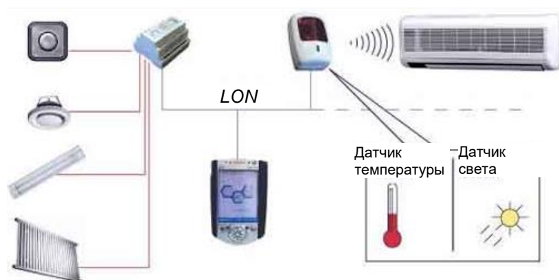
Рис. 17.12. Сеть по протоколу LonWorks
