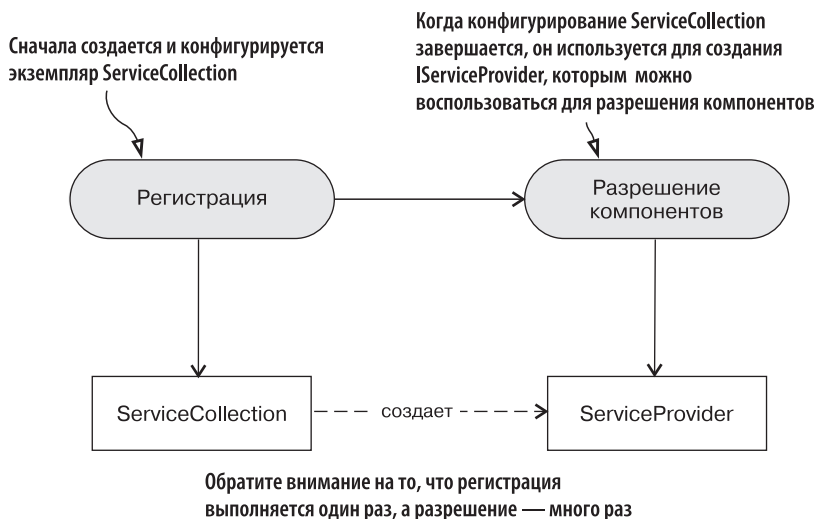
Рис. 15.1. Схема использования Microsoft.Extensions.DependencyInjection заключается в том, что сначала выполняется его конфигурирование, а затем проводится разрешение компонентов
