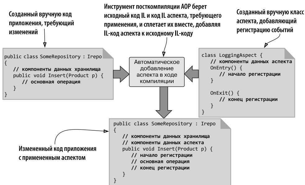
Рис. 11.4. Визуализация автоматического добавления аспектов в ходе компиляции
