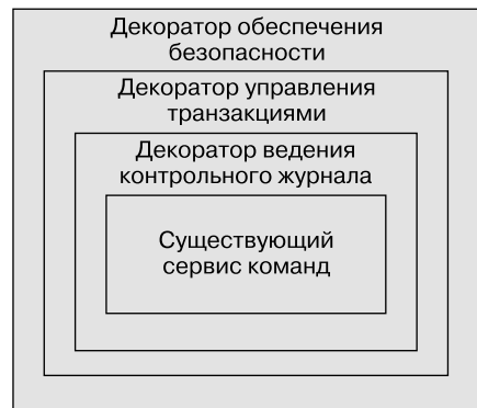
Рис. 14.6. Оснащение реального сервиса команд аспектами ведения контрольного журнала, управления транзакциями и обеспечения безопасности
