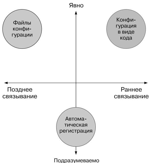
Рис. 12.5. Наиболее распространенные способы конфигурирования DI-контейнеров, показанные в зависимости от степеней явности и времени связывания
