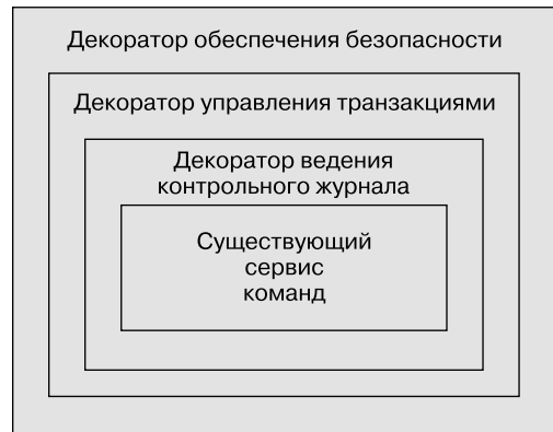
Рис. 10.4. Оснащение реального сервиса команд аспектами ведения контрольного журнала, управления транзакциями и обеспечения безопасности
