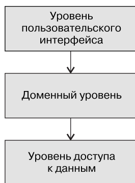
Рис. 2.9. Схема зависимостей при гипотетической ситуации, где зависимость пользовательского интерфейса от уровня доступа к данным удалена
