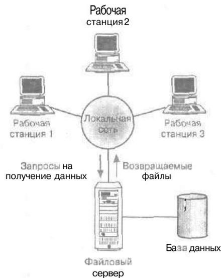
**Рис. 2.9.** Архитектура с использованием файлового сервера
