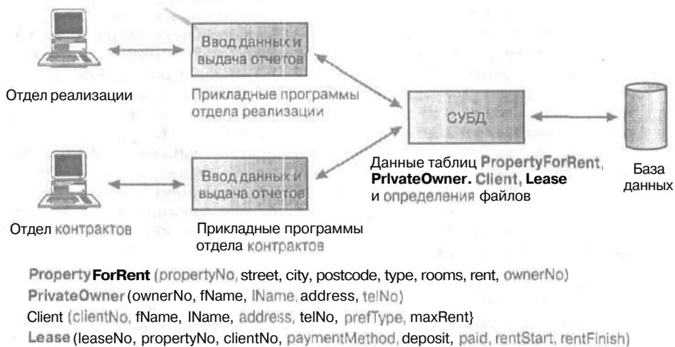
Рис. 1.5. Схема обработки данных с помощью СУБД
