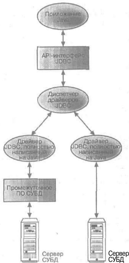
Рис. 28.10. Схема установки соединения JDBC с использованием драйверов только на языке Java
