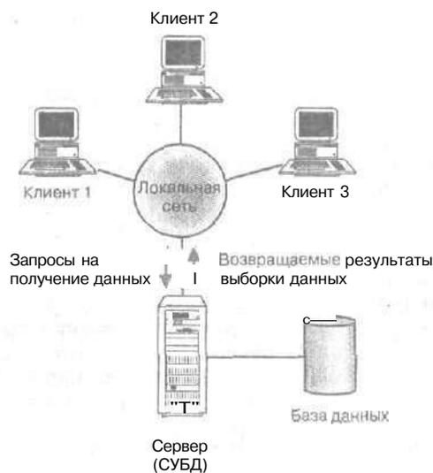
**Рис. 2.10.** Общая схема построения систем с архитектурой "клиент/сервер"
