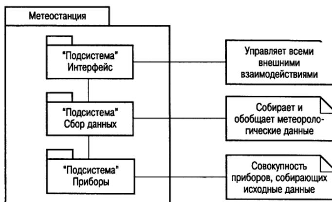
*Рис. 6.8. Архитектура метеостанции*
