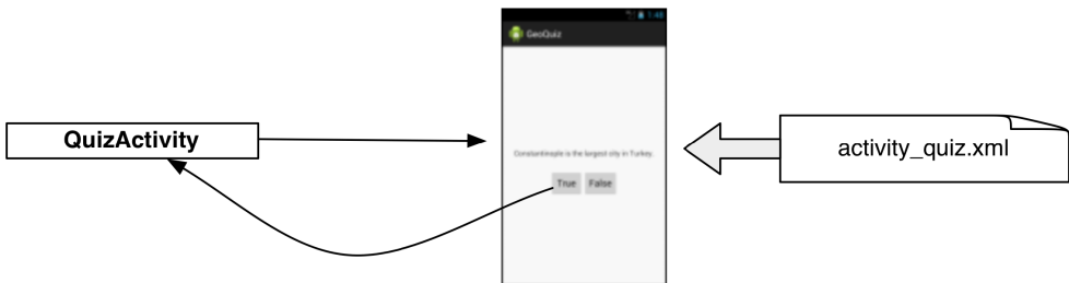
Рис. 1.2. QuizActivity управляет интерфейсом, определяемым в файле activity_quiz.xml
