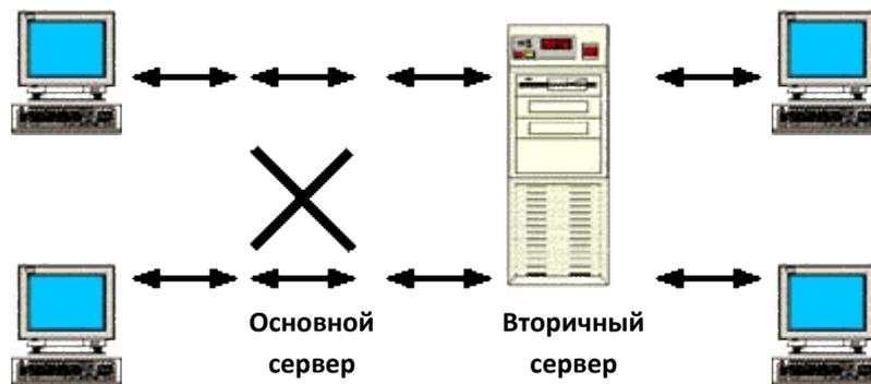
Рис. 5.2. Когда основной сервер выходит из строя, вторичный переводится в режим доступа и на чтение, и на запись
