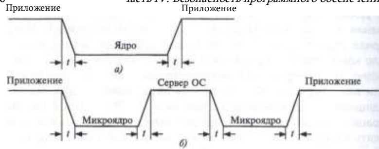
Рис. 15.14. Смена режимов при выполнении системного вызова
