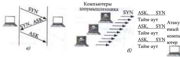
Рис. 9.3. Проведение DoS-атаки, в которой используются особенности протокола TCP: а — нормальный порядок установления TCP-соединения; б — DDoS-атака за счет создания множества незакрытых TCP-соединений
