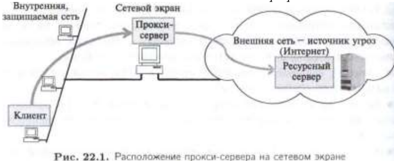
Рис. 22.1. Расположение прокси-сервера на сетевом экране
