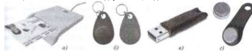
Рис. 5.1. Электронные устройства-аутентификаторы: а — смарт-карта; б — RFID-идентификаторы; в — USB-ключ; г — iButton
