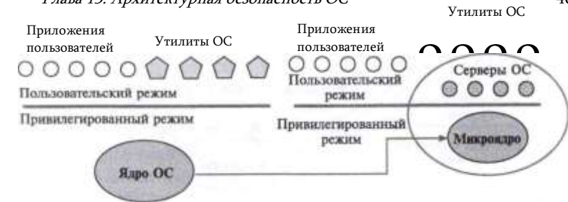
Рис. 15.12. Перенос основного объема функций ядра в пользовательское пространство
