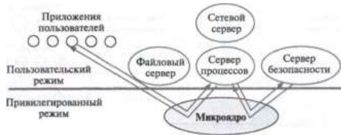
Рис. 15.13. Реализация системного вызова в микроядерной архитектуре
