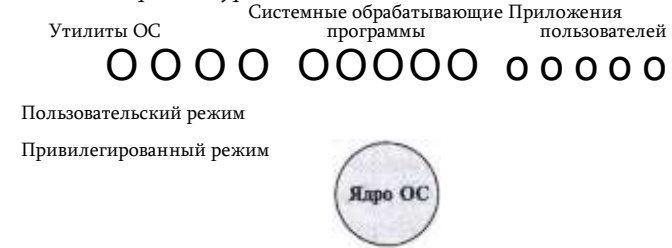
Рис. 15.10. Архитектура операционной системы с ядром в привилегированном режиме
