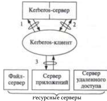
Рис. 16.5. Три этапа работы системы Kerberos: 1 — аутентификация пользователя, получение доступа в сеть и разрешение на дальнейшую авторизацию; 2 — авторизация Kerberos-сервера и получение доступа к ресурсному серверу; 3 — авторизация у ресурсного сервера и получение доступа к сетевому серверу (файлам, приложениям, устройствам)
