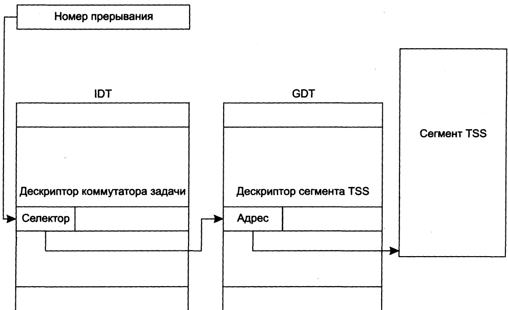
Рис. 4.13. Схема передачи управления при прерывании с переключением на новую задачу
