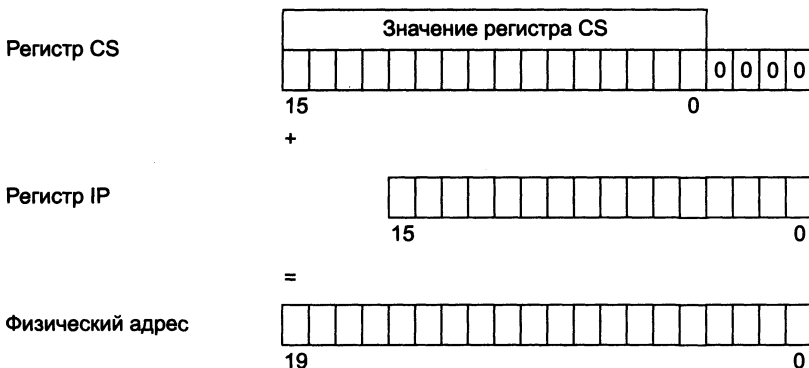
Рис. 4.1. Схема определения физического адреса для процессора 8086
