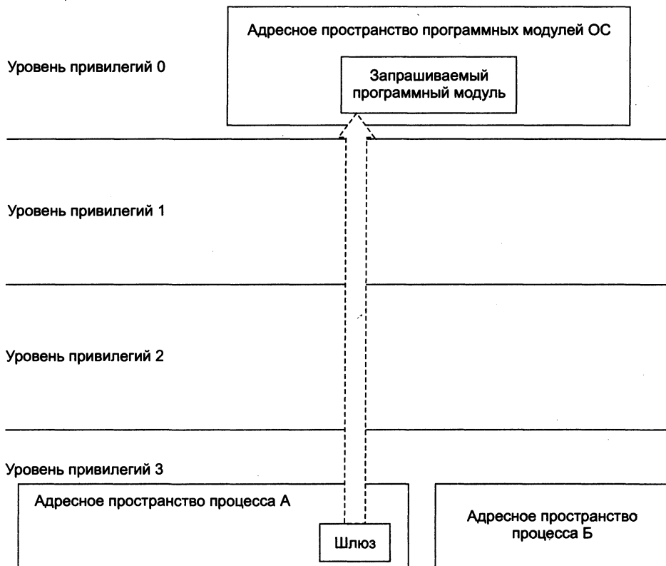
Рис. 4.9. Механизм шлюзов для перехода на другой уровень привилегий
