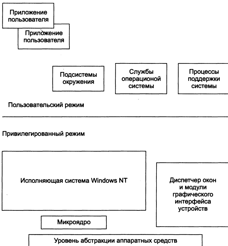
Рис. 11.2. Архитектура операционных систем класса Windows NT
