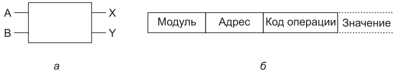
Рис. 8.26. Коммутатор 2 × 2 (а); формат сообщения (б)
