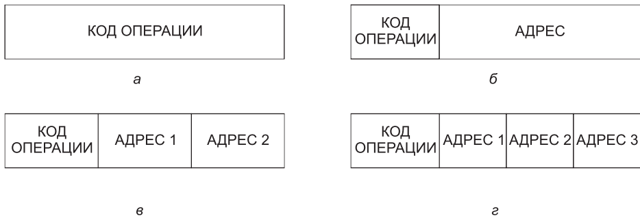
Рис. 5.5. Четыре формата команд: безадресная команда (а); одноадресная команда (б); двухадресная команда (в); трехадресная команда (г)
