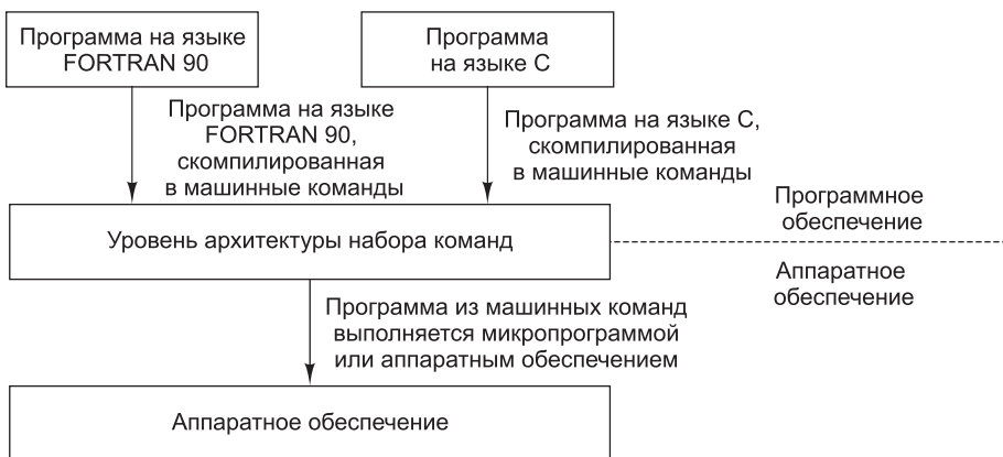
Рис. 5.1. Уровень архитектуры набора команд — это промежуточное звено между компиляторами и аппаратным обеспечением
