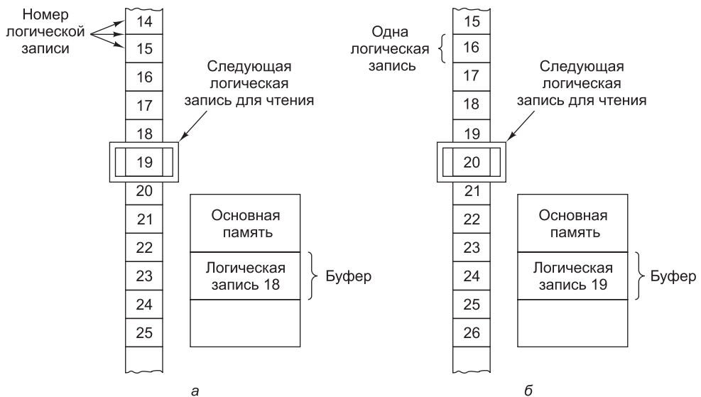
Рис. 6.19. Чтение файла, состоящего из логических записей: до чтения записи 19 (а); после чтения записи 19 (б)
