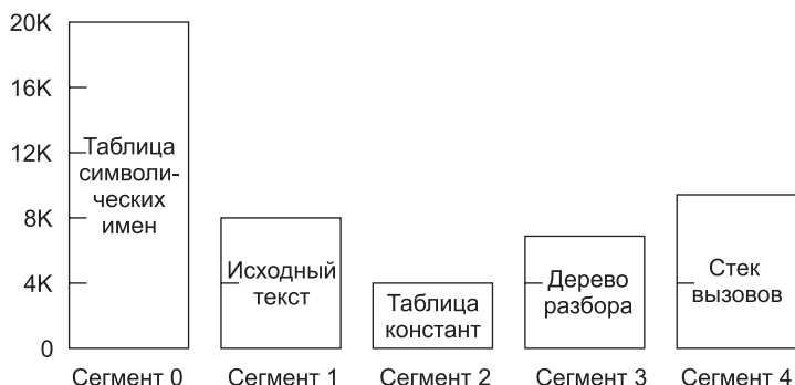
Рис. 6.8. Сегментированная память позволяет менять размер каждой структуры независимо от других
