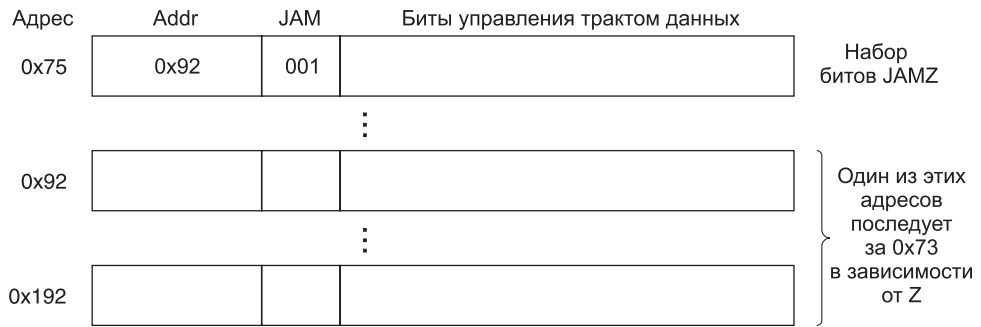
Рис. 4.6. Микрокоманда с битом JAMZ, равным 1, указывает на две потенциальные последующие микрокоманды
