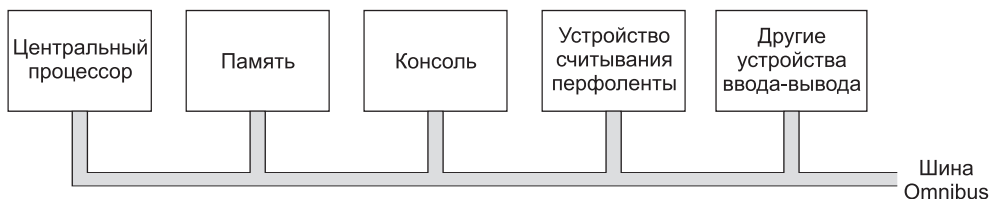
Рис. 1.5. Шина компьютера PDP-8
