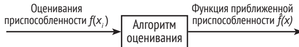
Рис. 21.1. Оценивание функции приспособленности. Мы используем точные значения функции приспособленности \{f(x_i)\} , для того чтобы аппроксимировать f(x) для x \notin \{x_i\}
