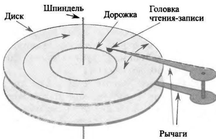
Рис. 18.2. Типичный дисковый накопитель. Он состоит из одного или нескольких дисков (на рисунке их два), вращающихся на шпинделе. Каждый диск считывается и записывается с помощью головки на конце рычага. Рычаги вращаются на общей опорной оси. Дорожка представляет собой поверхность диска, проходящую под головкой, когда та находится в зафиксированном положении.
