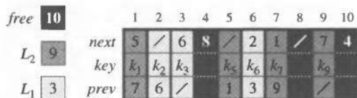
Рис. 10.8. Связанные списки L_1 (светло-серый) и L_2 (темно-серый) и обслуживающий их список свободных позиций (черный).
