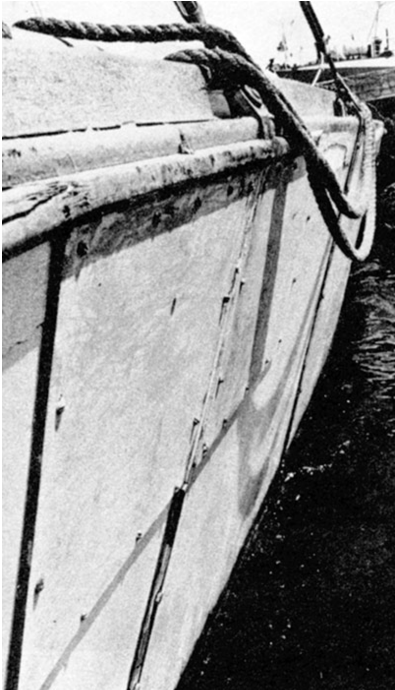
Две заплатки, привинченные к корпусу во время тайной остановки в порту Рио-Саладо. (Рон Холл/Sunday Times)
