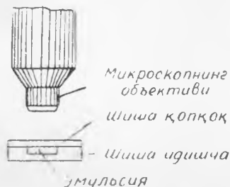
129-расм. Броун зарраларнинг микроскоп ёрдамида кузатиш усули.
