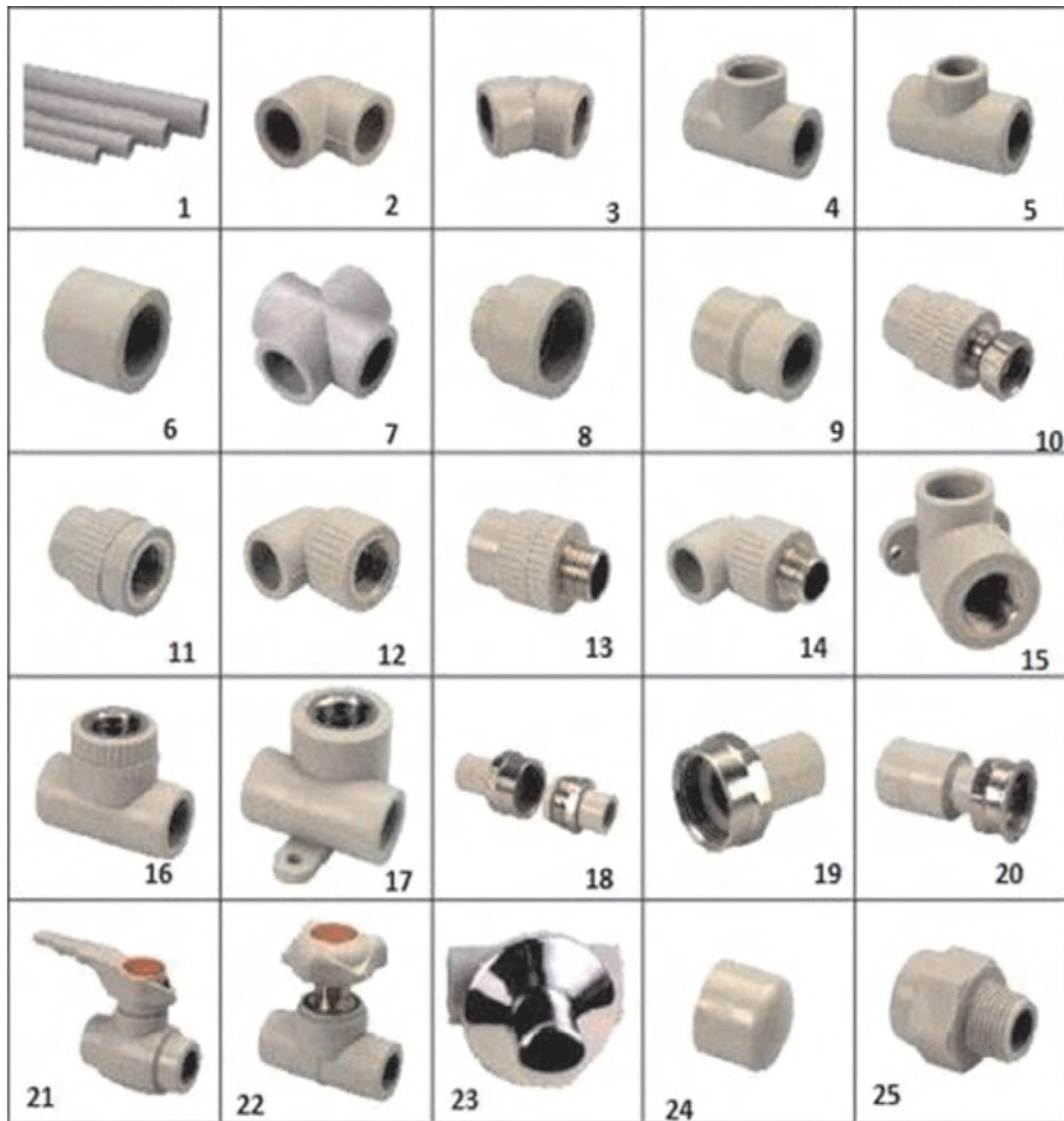
21-rasm. Plastmassa turbasiga oʻrnatiluvchi mahsus moslamalar. 1 – tuba, 2 – 90° li ulagich, 3 – 120° li ulagich, 4, 5 – tarmoqlagich, 6 – toʻgʻri ulagich, 7 – tekis tarmoqlagich, 8, 9 – oʻlchamni oʻzgartiruvch ulagich, 10, 11 – tashqi temir-plastmassa ulagich, 12 – tashqi 90° li temir-plastmassa ulagich, 13 – ichki toʻgʻri temir-plastmassa ulagich, 14, 15 – ichki 90° li temir-plastmassa ulagich, 16, 17 – tarmoqlagichdan ichki 90° li temir-plastmassa ulagich, 18, 19, 20 – tashqi temir ulagich, 21, 22 – plastmassa kalit, 23 – temir ulagich, 24 – toʻxtatgich, 25 – burab toʻxtatgich.
