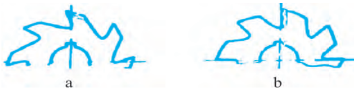
35-rasm. Frezerlarshakli: a) oʻtkircharxlangantishli, b) zatilovanniy.
