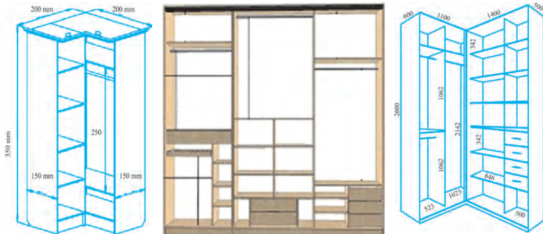
9-rasm. Turli xildagi shkaflarni tayyorlashda o'lcham olish va uni loyihalash ishlarini bajarish ish usullari
