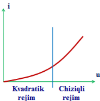
13.10- rasm. Amplitudaviy detektorning ish rejimlari
