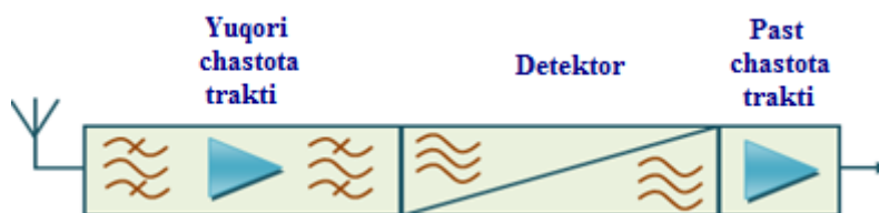
10.1- rasm. Radioqabul qilgichning eng oddiy tuzilish sxemasi
