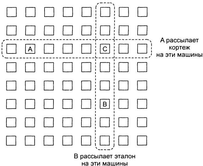
Рис. 12.16. Частичная рассылка обычных и эталонных кортежей
