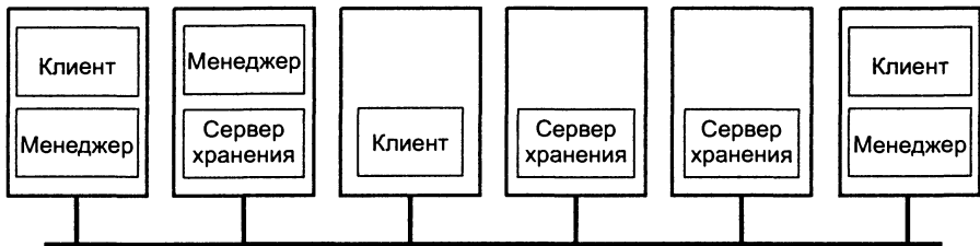
Рис. 10.29. Типичное распределение процессов xFS по нескольким машинам
