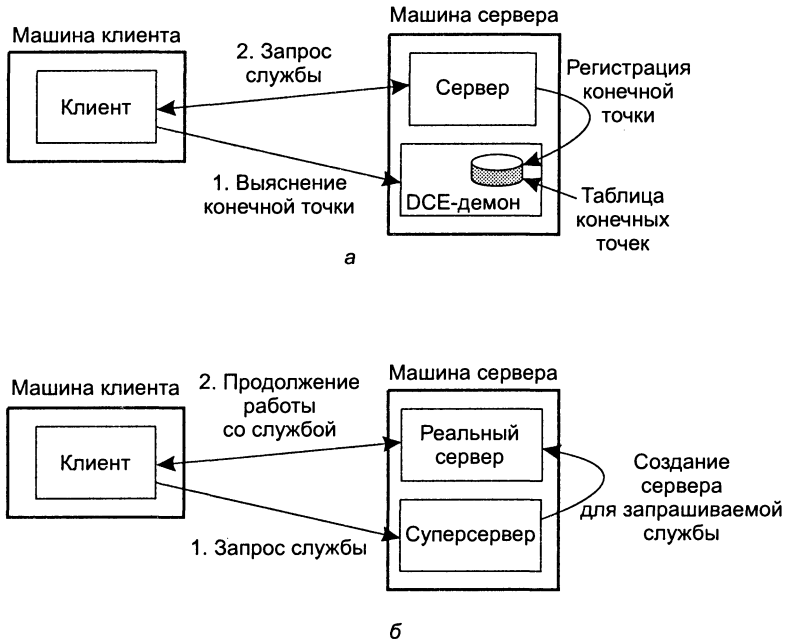
Рис. 3.6. Привязка клиента к серверу с использованием демона в среде DCE (а). Привязка клиента к серверу с использованием суперсервера в UNIX (б)
