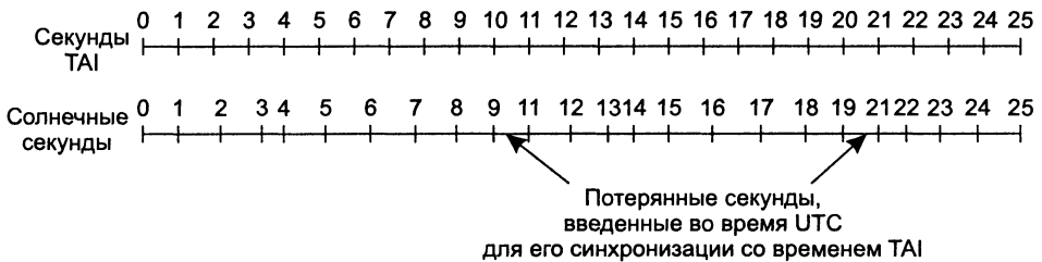
Рис. 5.3. Секунды TAI в отличие от солнечных секунд имеют постоянную длительность, поэтому для синхронизации времени UTC и времени TAI используют потерянные секунды
