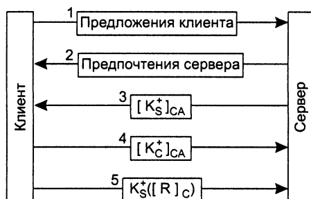
Рис. 11.16. Протокол TLS со взаимной аутентификацией
