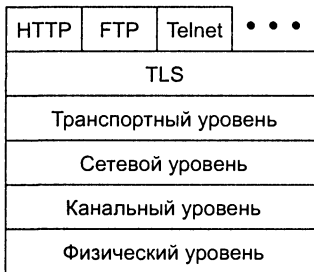
Рис. 11.15. Положение TLS в стеке протоколов Интернета
