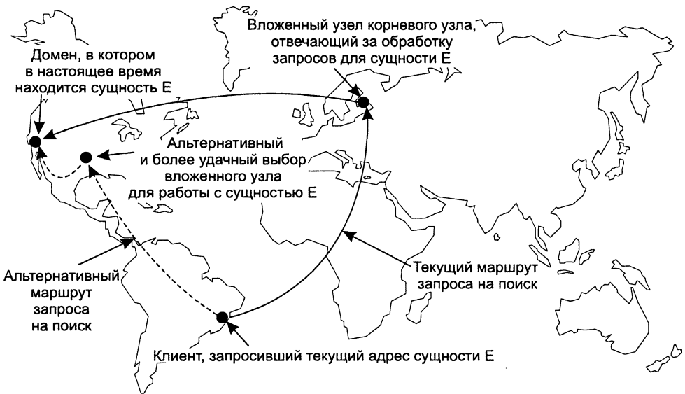
Рис. 4.21. Иллюстрация проблем масштабирования, связанных с задачей равномерного распределения вложенных узлов разделенного корневого узла
