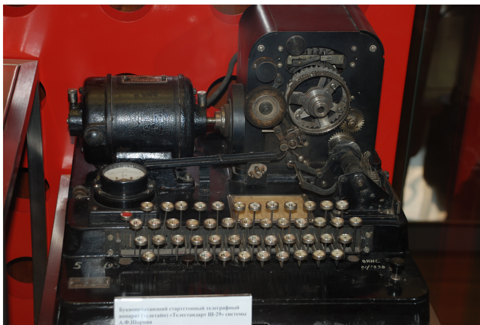
Рис. 9. Телетайп системы А. Ф. Шорина
