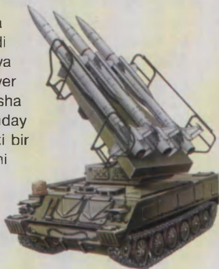
«Kub» zenit-raketa jamlamasi mo'ljalni 6–23 km uzoqlikda aniq nishonga oladi
