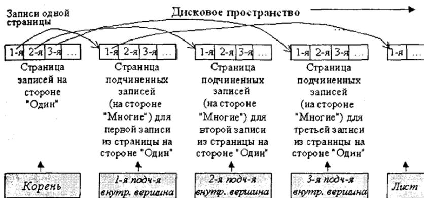
Рис. 2.15, а. Пример нелинейной древовидной иерархической структуры данных
