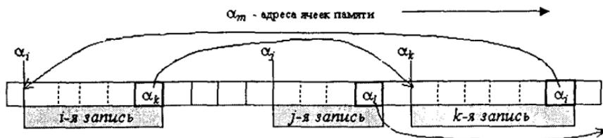
Рис. 2.14. Нелинейная структура данных на примере односвязного списка (поля указателей выделены жирными рамками)
