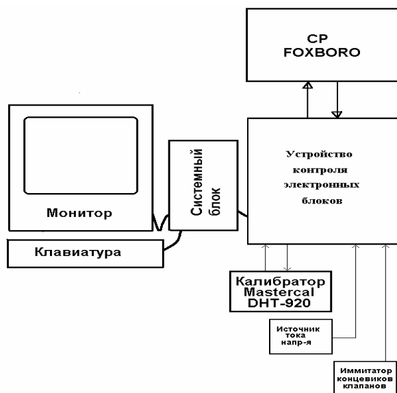
Рисунок 2 — Структурная схема для устройства контроля электронных блоков
