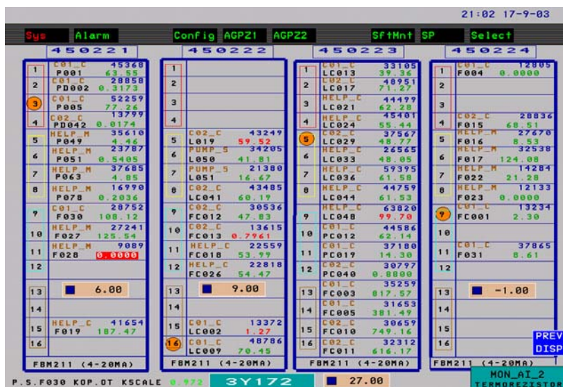
Рисунок 3 — Визуальный контроль аналоговых и дискретных параметров с помощью цветowych информационных матриц
