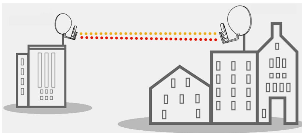
3.23- rasm. “Nuqta-nuqta” rejimidagi WiMAX tarmog‘ining topologiyasi
