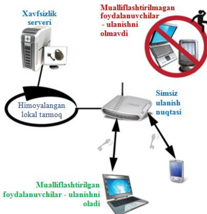
4.1- rasm. Xavfsizlik tizimining umumiy ishlash prinsipi
