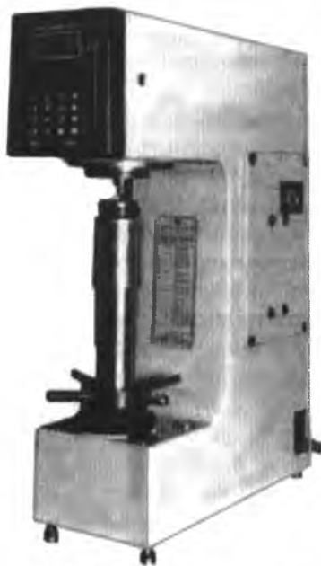
13.3-расм. Курилиш ашёларининг қаттиқлигини Роквелли усулида тестер билан аниқлаш асбоби.
