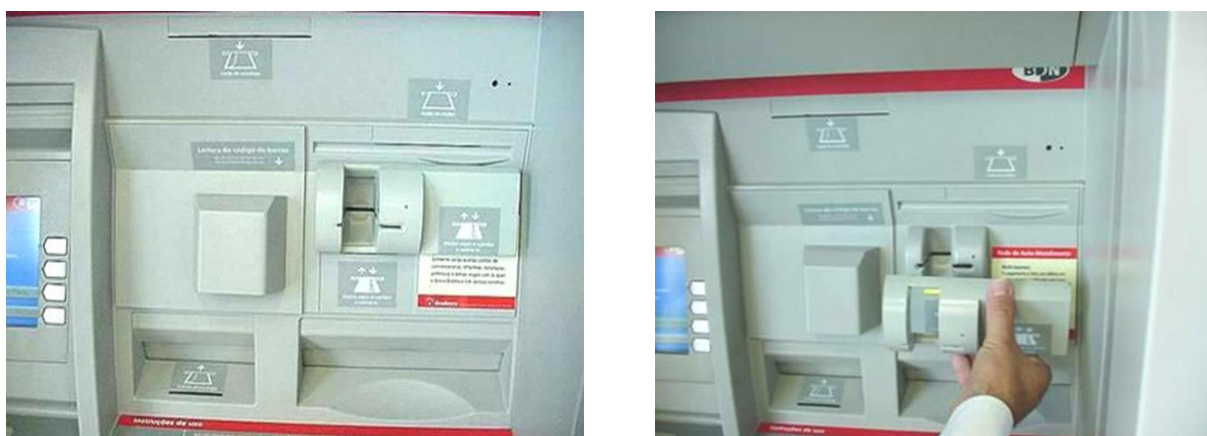
Рис.9. Приставка к банкомату, замаскированная под конструктивную часть
