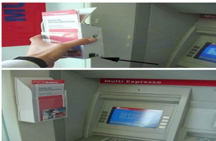
Рис.10. Видекамера, осуществляющая снятие вводимого клиентами пин-кода, замаскированная под лоток с рекламой
