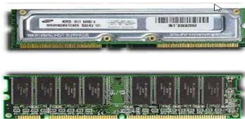
Расм 56. Хотира микросхемаси : RIMM(юқориси) ва DIMM(пасткиси).
