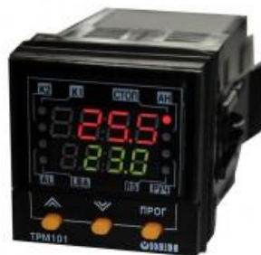
Расм 58. ТРМ-101 микропроцессорли ПИД контроллери.
