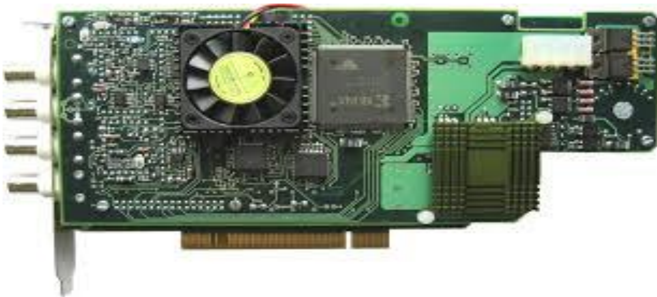
Расм 38. Аналог видео сигнални рақамли сигналга айлантириши қурилмаси.
