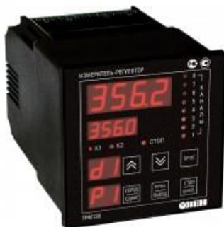
Расм 57. ТРМ-138 микропроцессорли универсал саккиз каналли бошқарувчи.
