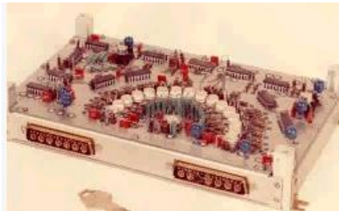
Расм 40. Кўп каналли аналог сигнални рақамли сигналга айлантириш қурилмаси.
