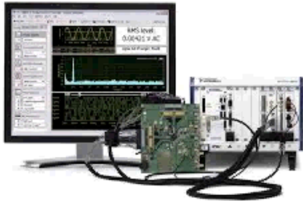
Расм 41. Аналог сигнални рақамли сигналга айлантириш қурилмасини тахлил этишни компьютерли тизими.
