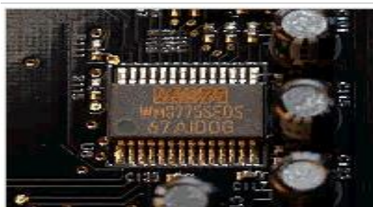
Расм 39. Аналог сигнални рақамли сигналга айлантириш қурилмаси.
