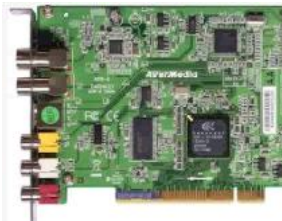
Расм 42. Видео аналог сигнални рақамли сигналга айлантириш қурилмаси.
