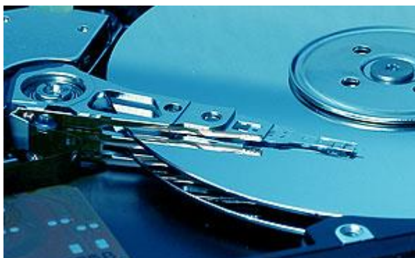
Расм 26. Винчестерда магнит усулда информацияни ёзиш ва ўқиш каллаги(головкasi).
