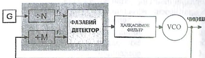
7.2-расм. PLL асосидаги частота синтезатори.
