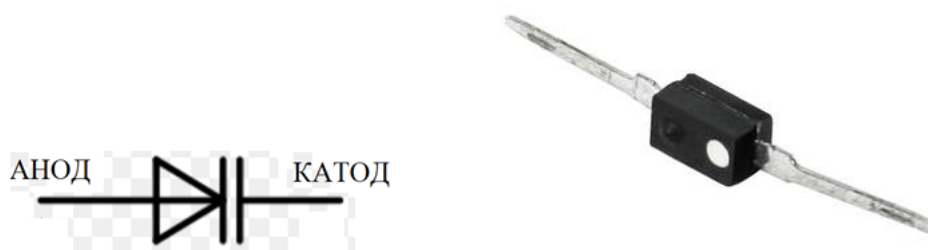
Рис.9.3. Обозначение на схеме (слева) и внешний вид (справа) варикапа
