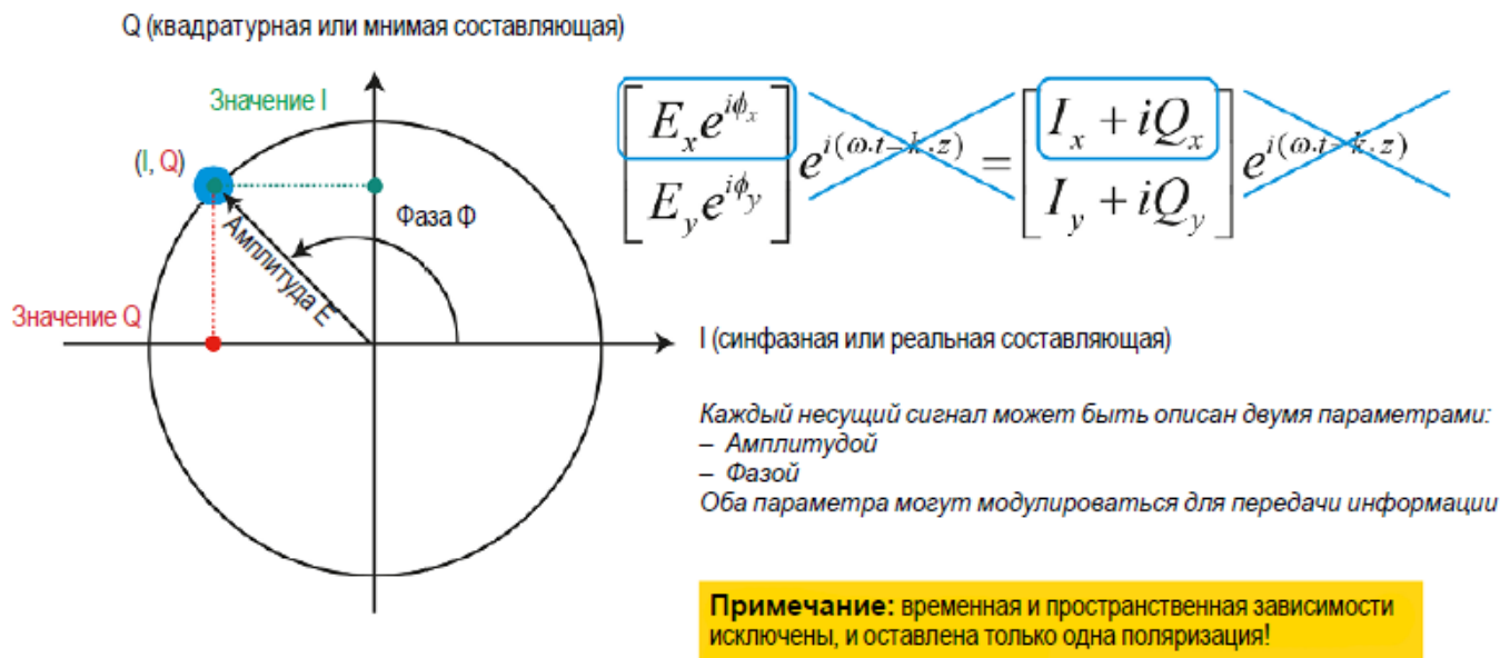
Рис.6.7. Отображение электрического поля модулированного сигнала на комплексной плоскости с помощью I/Q -диаграммы
