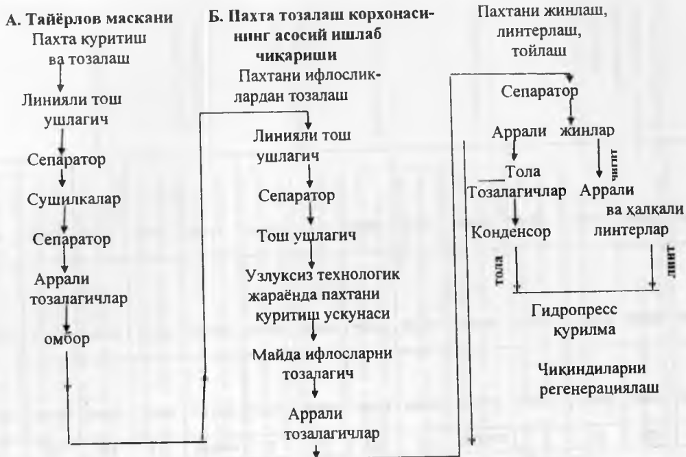
10-чизма. Пахта тозалаш корхонасининг технологик жараёни схемаси
