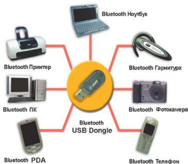
Рис. 3.2. На базе универсального приемопередатчика Bluetooth-dongle обеспечивается связь с различными Bluetooth-устройствами
