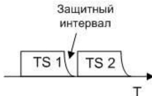
Рис. 1.9. Защитные интервалы в цикле TDMA
