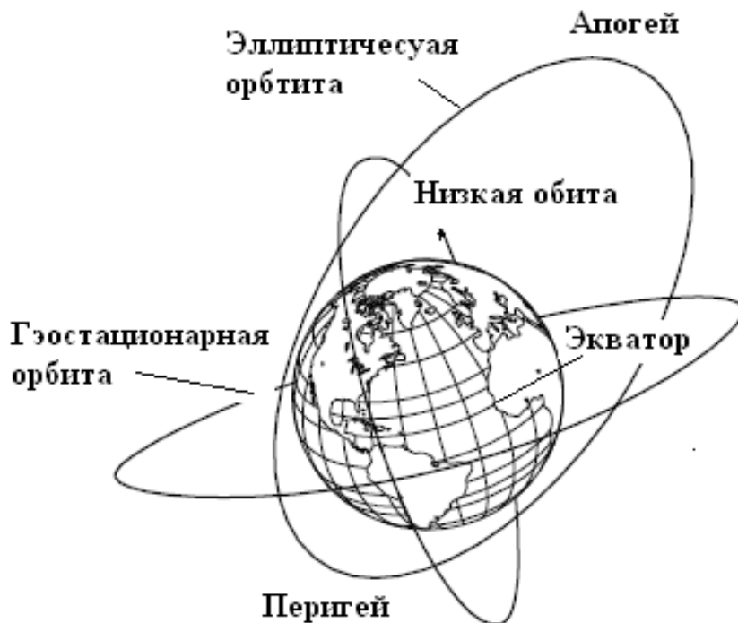
Рис. 4.6. Типы орбит в системах спутниковой связи
