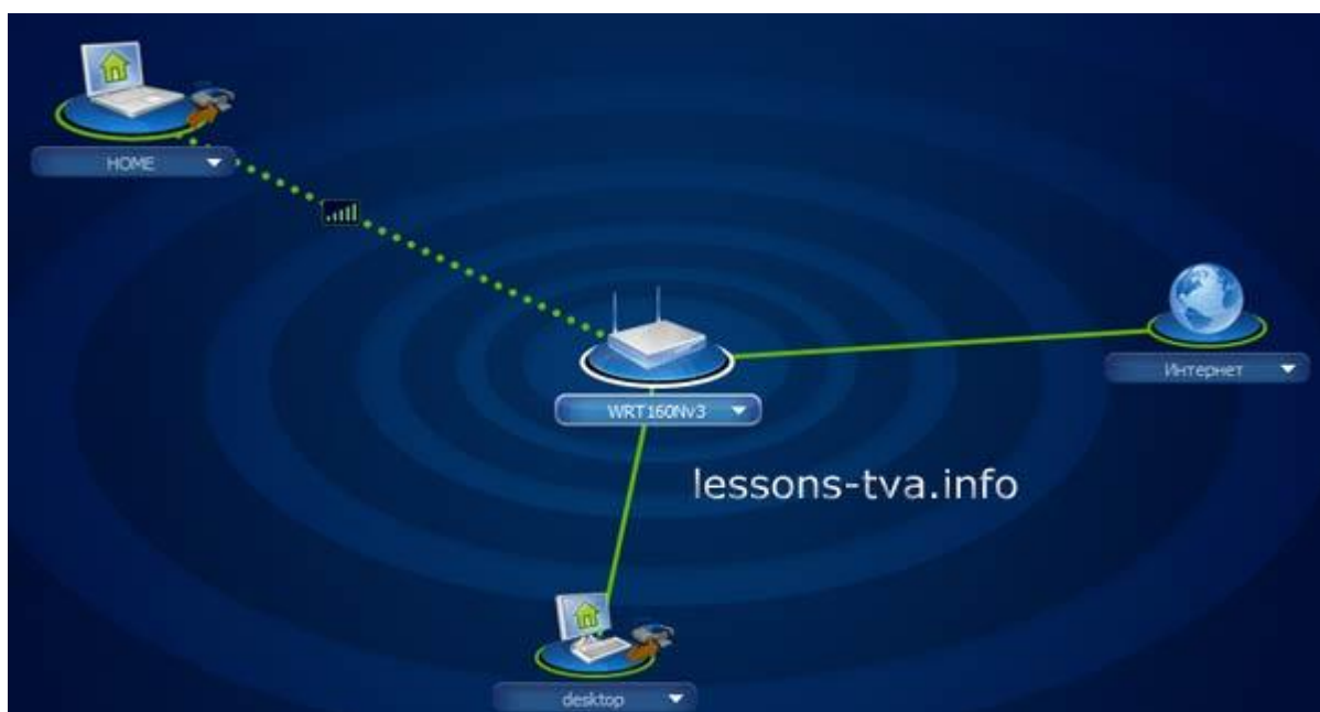
2.23- расм. Асосида Интернетга чиқишли SOHO симсиз тармоғи қурилган
