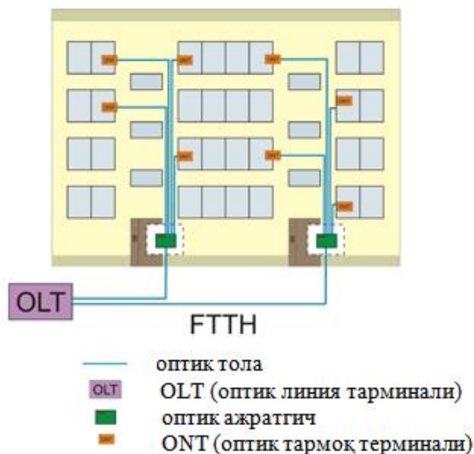
1.11- расм. FTTH абонент уланиш технологияси
