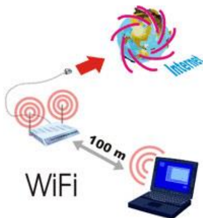
2.3- расм. Wi-Fi тармоғи тузилиши
